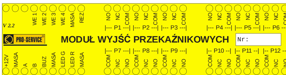
Rys. 11. – Płyta czołowa modułu wyjść przekaźnikowych centrali modularPAG®.
