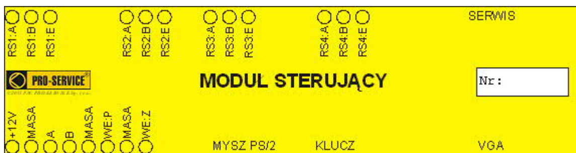
Rys. 9. – Płyta czołowa modułu sterującego centrali modularPAG ® .
